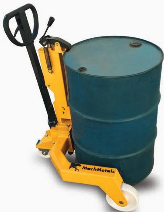
Dispositivo completo para transporte manual de tambores de aço com até 220 litros. Com um prático método de funcionamento, basta rolar o carrinho até a base do tambor, ajustar a altura através do elevador hidráulico e completar a elevação. Com isso o Carrinho está pronto para transportar o tambor com segurança e praticidade.
